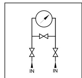
**manifold a 3 valvole da barra, blocco ed equalizzazione,
